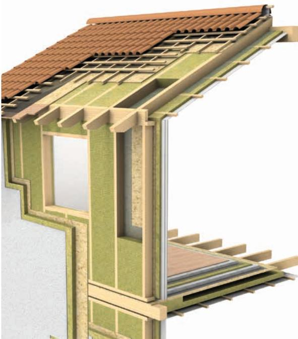
Solución formada por paneles aislantes **ROCKSATE DUO PLUS** de 80 mm de espesor, sobre estructura de madera de entramado ligero (Timber frame) cerrada mediante dos tableros de madera tipo OSB con un espesor de 15 mm cada uno o de partículas con caras de fibras de madera tipo SuperPan Tech P5 de FINSA.
